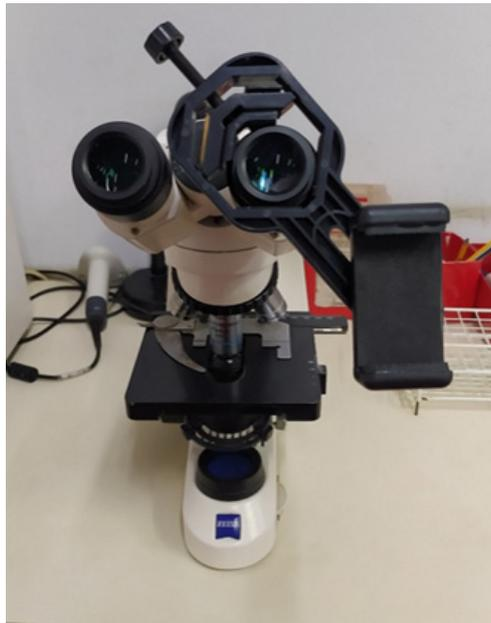
**Figura 2.** Se utilizó un microscopio Carl Zeiss modelo Primo Star con la técnica de Campo claro. Se adiciona un adaptador en el ocular derecho que ayuda a fijar equipos para fotografía ya sean celulares o cámaras digitales.
