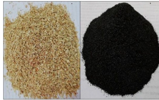
Figura 2. Material para carbonización, a) Materia prima y b) Biocarbón (CC-B).
